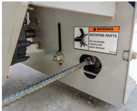
Шнек, стандартно оборудованный полым валом, может использоваться для установки продольной арматуры
