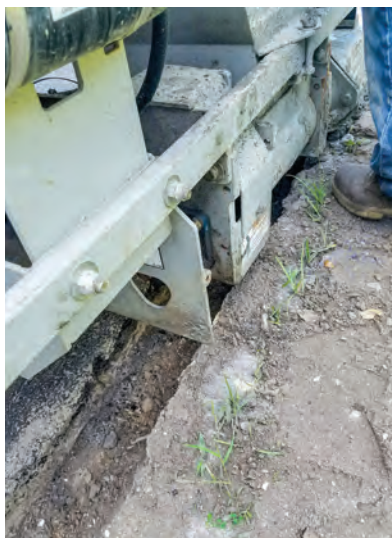
Бордюроукладчик 150 с легкостью укладывает бордюры с траншейным основанием
