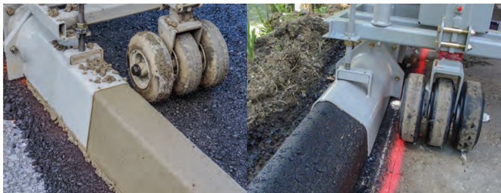
Бордюроукладчик может использовать как бетонную, так и асфальтную смесь. Пневмошины на рисунке слева – стандарт. Колеса из цельной твердой резины на рисунке справа – опция.
